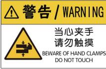
**警告：**当心被机器卷入。在机器拉动薄膜、为薄膜充气或封口时，请勿将手指、头发、首饰、衣服等靠近滚轮和拉料轮。
