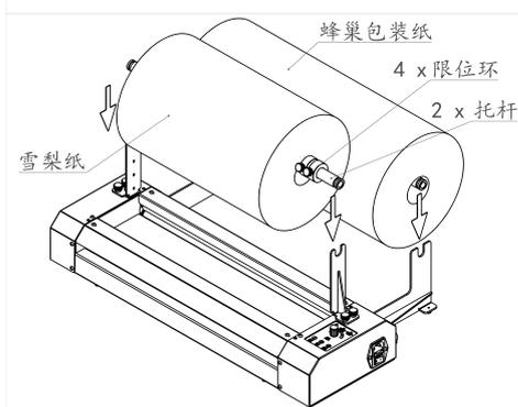
3、开启机器，把纸靠近滚筒，机器滚筒会自动把蜂窝包装纸吸入
