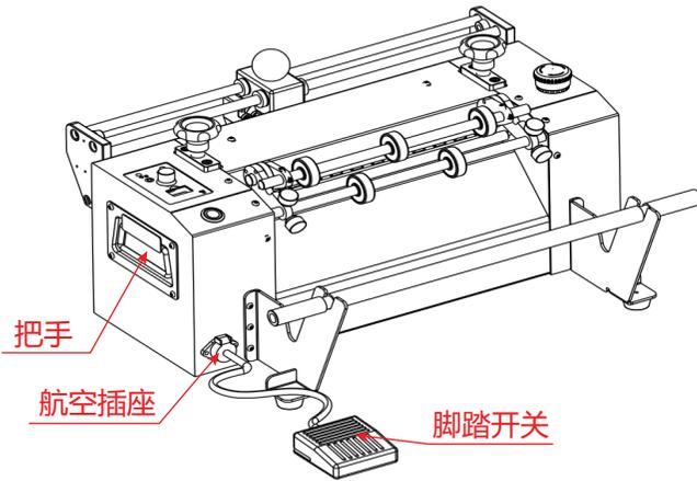
图2 (FWE压泡纸机器全图)
