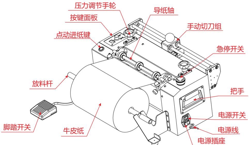
图1 (FWE压泡纸机器全图)
